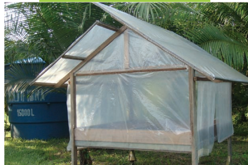
Secador solar de castanha na RDS do Juma
